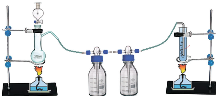
28-расм. Этил спиртини олиш учун йиғилган асбоб
