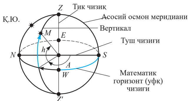
68-расм. Юлдузларни кузатиш учун керакли горизонтал координаталар тизими
