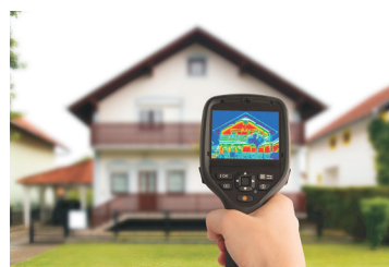
197-расм. Тепловизорни қўллаш орқали уйн иссиқлик иўқотишини текшириш
