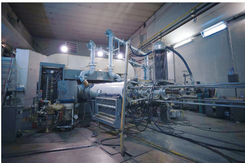
213-расм. Қозоғистон Республикаси Энергетика министрлигининг Ядро физика институтидаги У–150М изохронли циклотрон.
