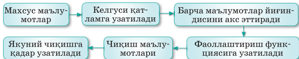
11-схема. Нейрон тизимининг ишлаш тамойили
